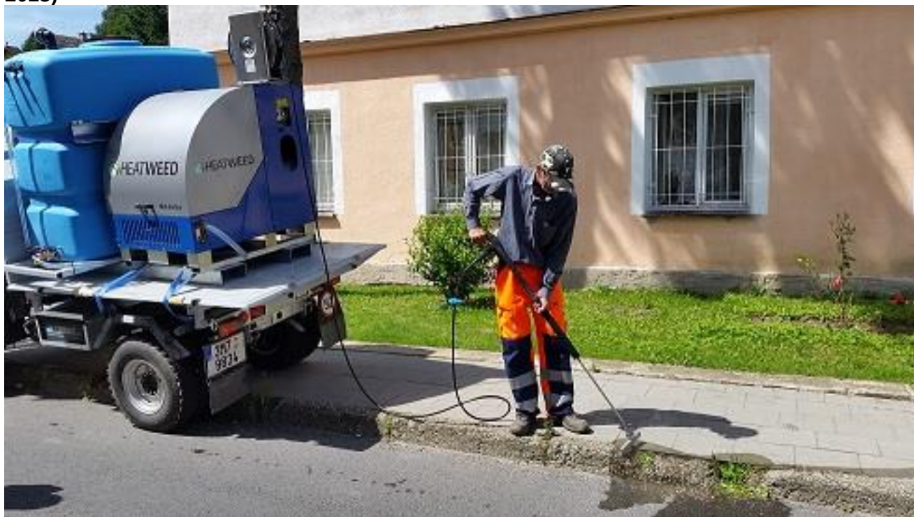
Obr. 34: Stroj pro likvidaci plevelů horkou vodou s obsluhou (realizováno v roce 2018)
