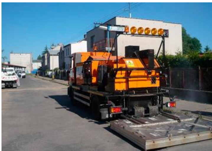
Obr. 8: Souprava pro ochranu komunikací
